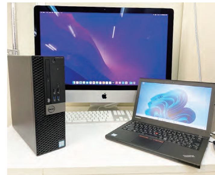
検査、修理、クリーニング、試験の工程を経て再製品化されたパソコン
